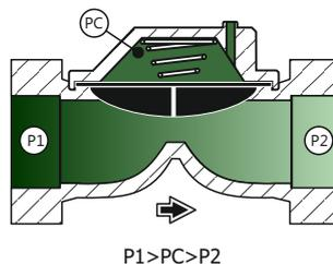
Por medio de un piloto de regulación se puede controlar la presión en la cámara, determinando una posición intermedia de la membrana finalizada a la regulación de los parámetros hidráulicos requeridos (presión, caudal o ambos).
