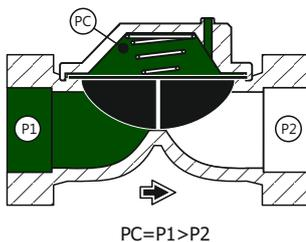
Para su operación, la válvula requiere un circuito hidráulico que controle la entrada y la salida de agua a la cámara. La presión PC ejerce su fuerza sobre la superficie interna de la membrana que resulta mayor de la superficie externa donde actúa la presión P1.
