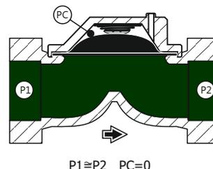
Aislado el circuito de alimentación y poniendo la cámara a la atmósfera, la membrana se levanta y deja el paso totalmente abierto.
